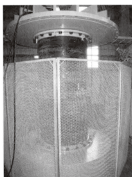
写真：呼び径900 荷重1350kN (1.5DkN) 異状なし
