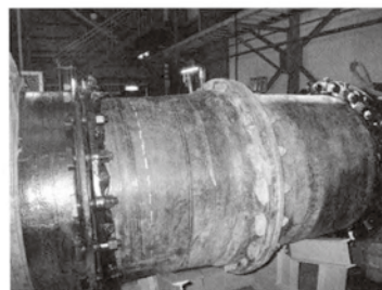
写真：呼び径900 水圧0.75MPa異状なし
