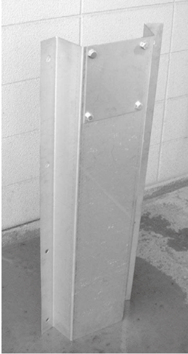
バッフルプレート
