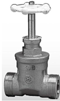
弁体にゴムを焼き付けたソフトシール型の仕切弁です。一般の仕切弁より低トルクで止水出来ます。
