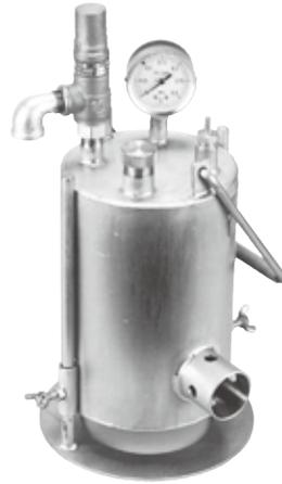
配管内の水が凍結した場合に、この水解ボイラーから出る水蒸気の熱によって解凍します。特に電気解氷機を使用できない場合（ポリパイプ、塩ビパイプなど）に有効です。容量は3.0ℓです。
