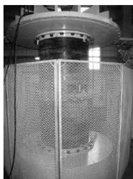
写真：呼び径900 荷重1350kN (1.5DkN) 異常なし
