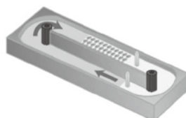
二点DO制御システム
