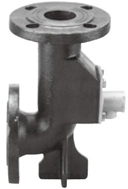
排泥水抜弁は本管工事などで管内に混入した土砂の排出作業後、凍結防止のため自動的に水抜きをする器具です。
