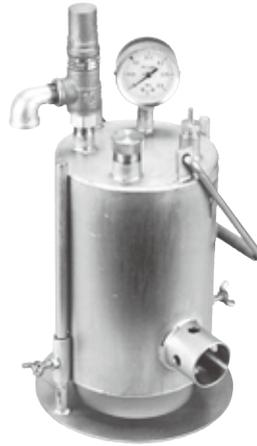
配管内の水が凍結した場合に、この氷解ボイラーから出る水蒸気の熱によって解氷します。特に電気解氷機を使用できない場合(ポリパイプ、塩ビパイプなど)に有効です。容量は3.0ℓです。
