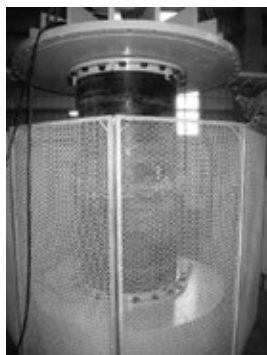
写真：呼び径900 荷重1350kN (1.5DkN) 異常なし
