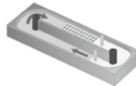
二点DO制御システム
