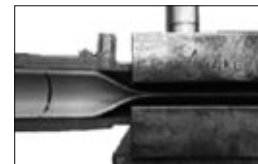
EF接合部の試験例 圧縮はく離試験の実施状況
