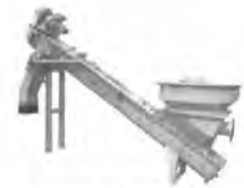
エスカルゴ（沈砂分離機）
