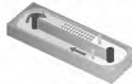
二点DO制御システム
